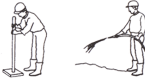
Resim 1.8: Zeminin sıkıştırılması ve sulanması
